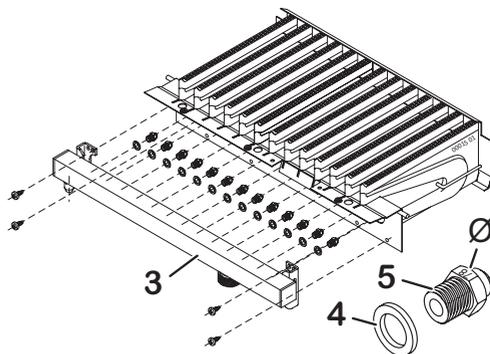
7. Снимите панель **3** и замените форсунки **5\*** на соответствующие для используемого типа газа, для этой операции необходим специальный ключ на 7 мм (см. рисунок). Число необходимых форсунок и их диаметр « $\varnothing$ » (также указан непосредственно на форсунке) приведены в таблице «Технические характеристики» на стр. 38.
