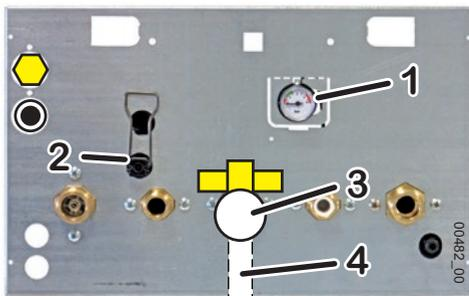
**ВАЖНО:** Приведите пружинную ручку в вертикальное положение и поверните ее, чтобы открыть (1 оборот, максимум 2) или закрыть кран. При закрытии не используйте инструменты, а полностью затяните вручную, не прилагая усилий: уплотнение клапана наполнения зависит не от силы зажима, а только от его целостности и правильности использования. По окончании операции можно оставить пружину опущенной или вернуть ее в горизонтальное положение.
