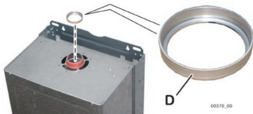
**(i)** Сверьтесь с таблицами, рассчитайте эквивалентную линейную длину с учётом каждого дополнительного колена (исключая уже изображённые на рисунке) и, при необходимости, установите диафрагму D, как указано на рисунке.
