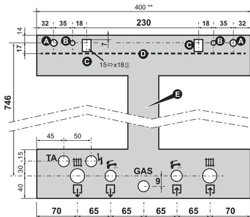
**Примечание:** Как дополнительная опция предлагается специальный металлический шаблон многоразового использования (D на рисунке), облегчающий позиционирование точек крепления (с использованием оригинального Комплекта подсоединения). Если не используется металлический шаблон многоразового использования и / или оригинальный Комплект подсоединения, о позиции гидравлических подключений котла можно прочитать в параграфе «Габаритные и присоединительные размеры» на стр. 14.
